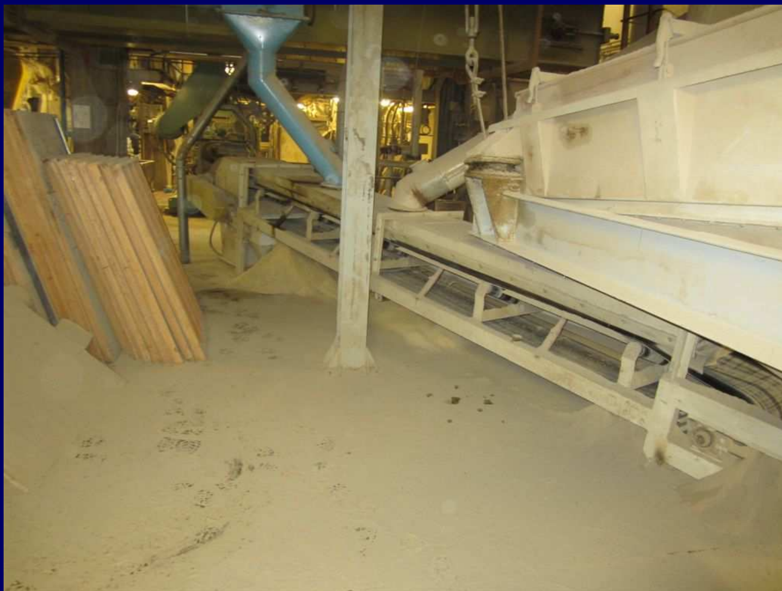
Vaglio vibrante: dispersione e accumuli di polvere
